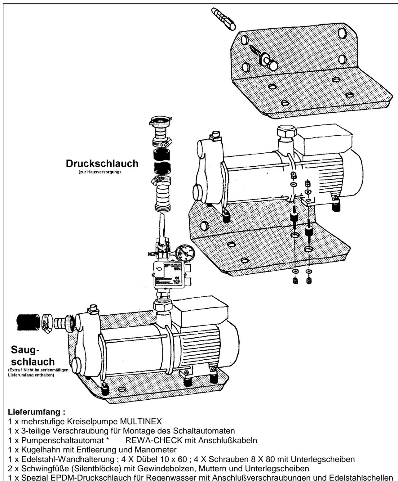
\* Bei Steuerzentralen ist der Pumpenschaltautomat in der Steuerzentrale enthalten.
